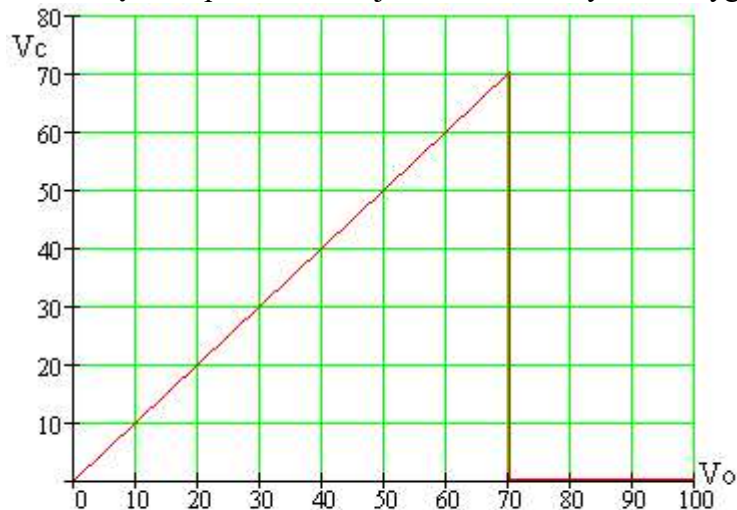
Ryc. 1. Efektywność przekazywania prędkości i energii ruchu podczas sprężystego czołowego zderzenia dwóch cząstek
