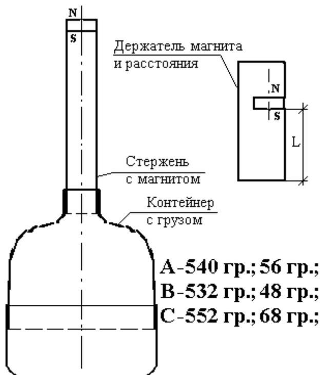
Измерение силы притяжения и отталкивания магнитов - таблеток при помощи электронных весов - дискретность показаний 2 грамма.
