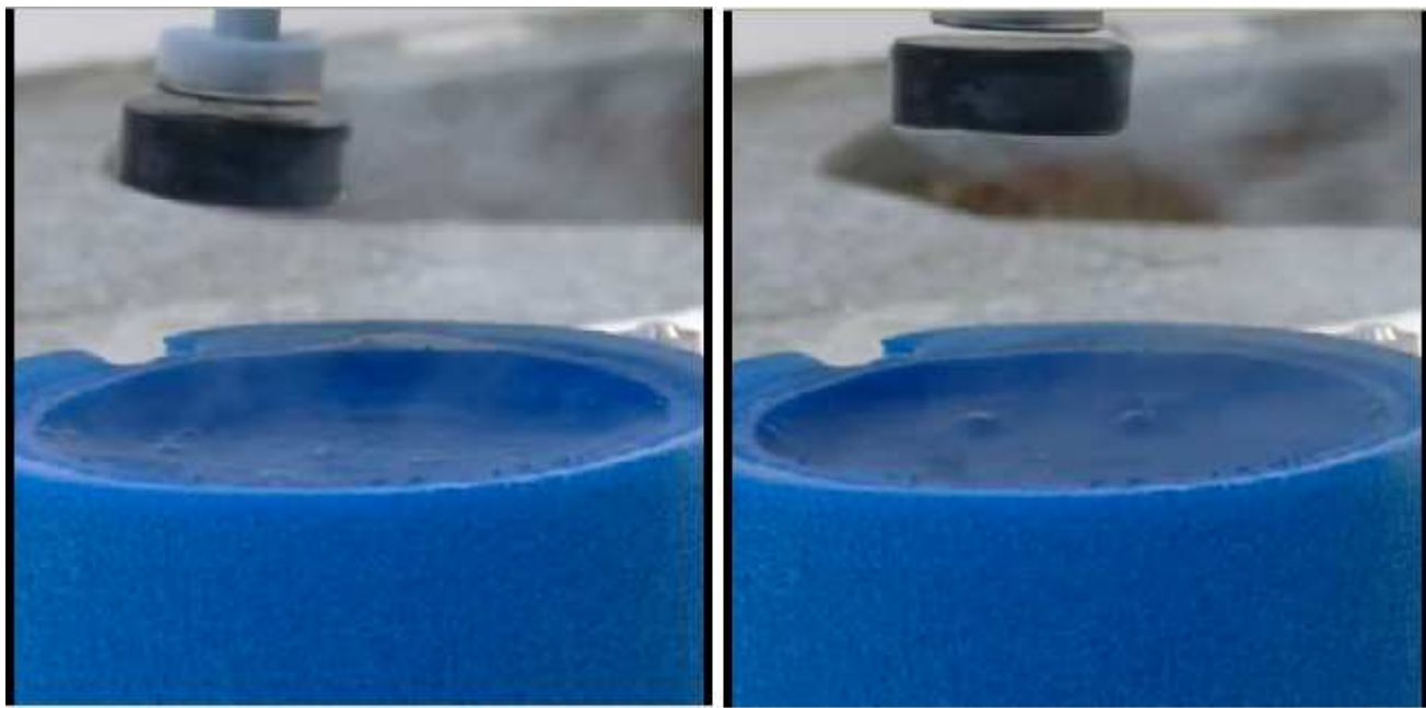
Lewitacja diamagnetyku pod magnesem - dwie fotografie procesu zrobione w odstępie kilku sekund. Левитация диамагнетика под магнитом - 2 фотографии сделаны в течении нескольких секунд.
