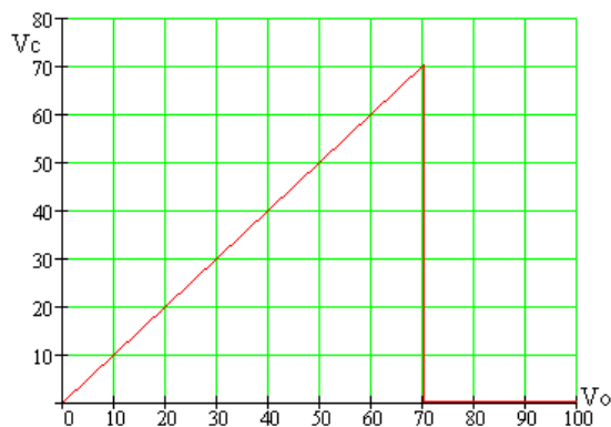
Рис. 1. Эффективность передачи скорости и энергии движения во время упругого лобового столкновения двух частиц
